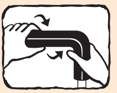
Durch das flexible Material ist es möglich, auch ohne aufwendige Gehrungsschnitte Rohrbögen zu isolieren.
