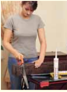
Balken mit Feinsäge schneiden
