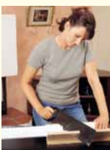
Zierprofil zuschneiden mit DECOSA- Gehrungslade
